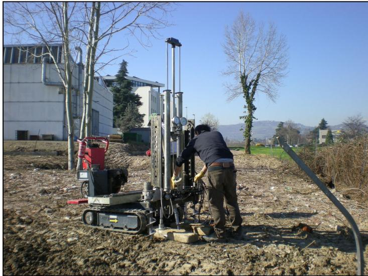
**FOTO 1** – ESECUZIONE PROVA PENETROMETRICA CPT1.
