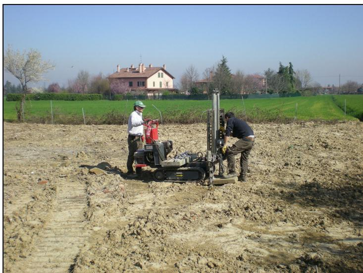
**FOTO 3** – ESECUZIONE PROVA PENETROMETRICA CPT3.
